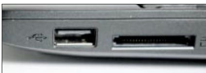
Ein dritter USB-Port und der Speicherkarten-Steckplatz befinden sich ebenfalls an der rechten Seite
