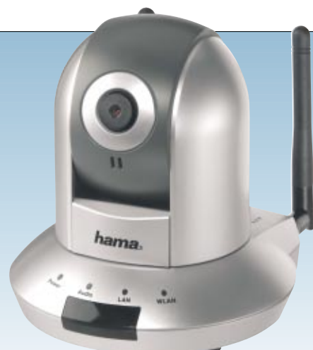
▲ Die WLAN-Kamera M360 von Hama lässt sich via Internet elektronisch drehen und schwenken
