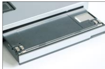
Befindet sich das optische Laufwerk in einem Modulschacht, ist ein schneller Austausch gegen andere Komponenten möglich
