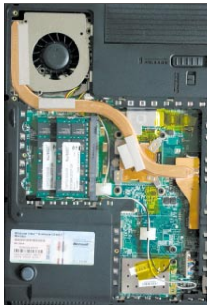
Je leistungsstärker Prozessor und Grafikchip, umso mehr Wärme muss das Lüftersystem aus dem Gerät befördern
