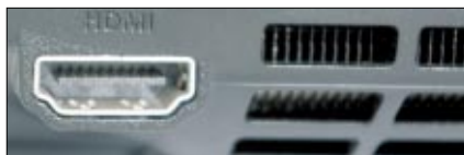
Ein HDMI-Port ermöglicht eine komplett digitale Übertragung von hochauflösendem Videomaterial
