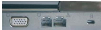
Auch einen analogen RGB-Port, Buchsen für Modem- und Netzwerkverbindungen sowie ein Kensington-Lock hat das M70 zu bieten
