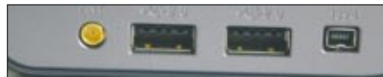
Den Antenneneingang, zwei weitere USB-Ports und die Firewire-Schnittstelle hat Asus auf der linken Seite platziert
