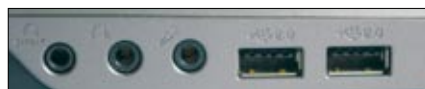
An der rechten Seite befinden sich die Audio-Anschlüsse sowie zwei der vier USB-Ports
