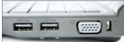
Nur die wichtigsten Anschlüsse sind vorhanden, dazu zählen USB-Ports und ein Monitoranschluss
