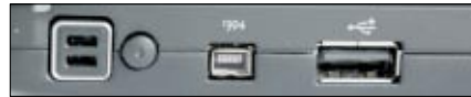
Der Zeigestift, die Firewire-Schnittstelle und einer der USB-Ports sind an der linken Seite zu finden
