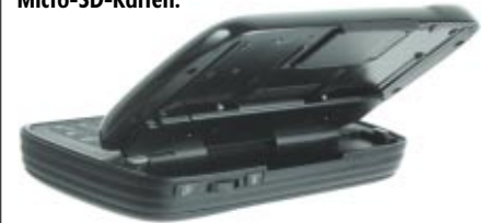
▲ Der raffinierte Schiebe- und Aufstell-Mechanismus beruht auf metallenen Bauteilen und wirkt daher recht stabil. Man kann das Display auch flach lassen.
