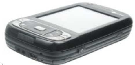
▲ Geladen wird der TyTN II über eine Mini-USB-Buchse, in die auch das Headset kommt. Darüber zu sehen: Der verdeckte Steckplatz für Micro-SD-Karten.
