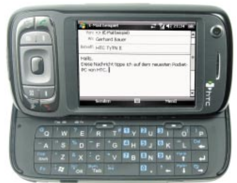
▲ Die komfortable Tastatur lässt sich herauschieben, das Display bei Bedarf aufstellen. Unser Testgerät hatte ein englisches Tastaturlayout, bei den Seriengeräten wird aber die QWERTZ-Belegung vorhanden sein.
