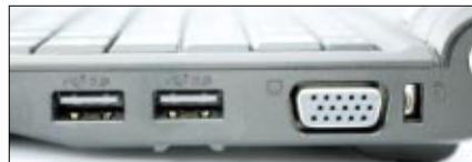
Zwei der drei USB-Ports, der Monitoranschluss und das Kensington-Lock befinden sich auf der rechten Seite
