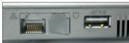
Die Netzwerkbuchse und ein dritter USB-Port sind an der linken Seite platziert
